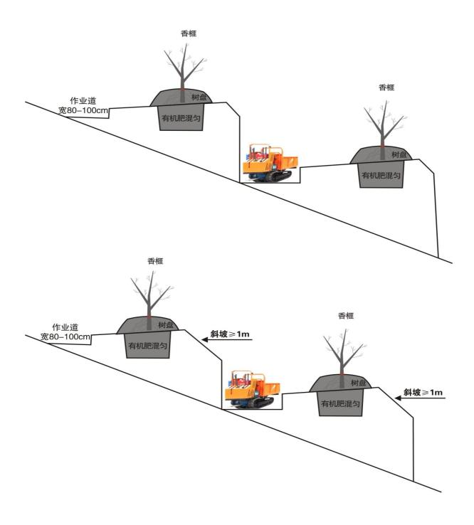
图 B 机械化水平带建设示意图
